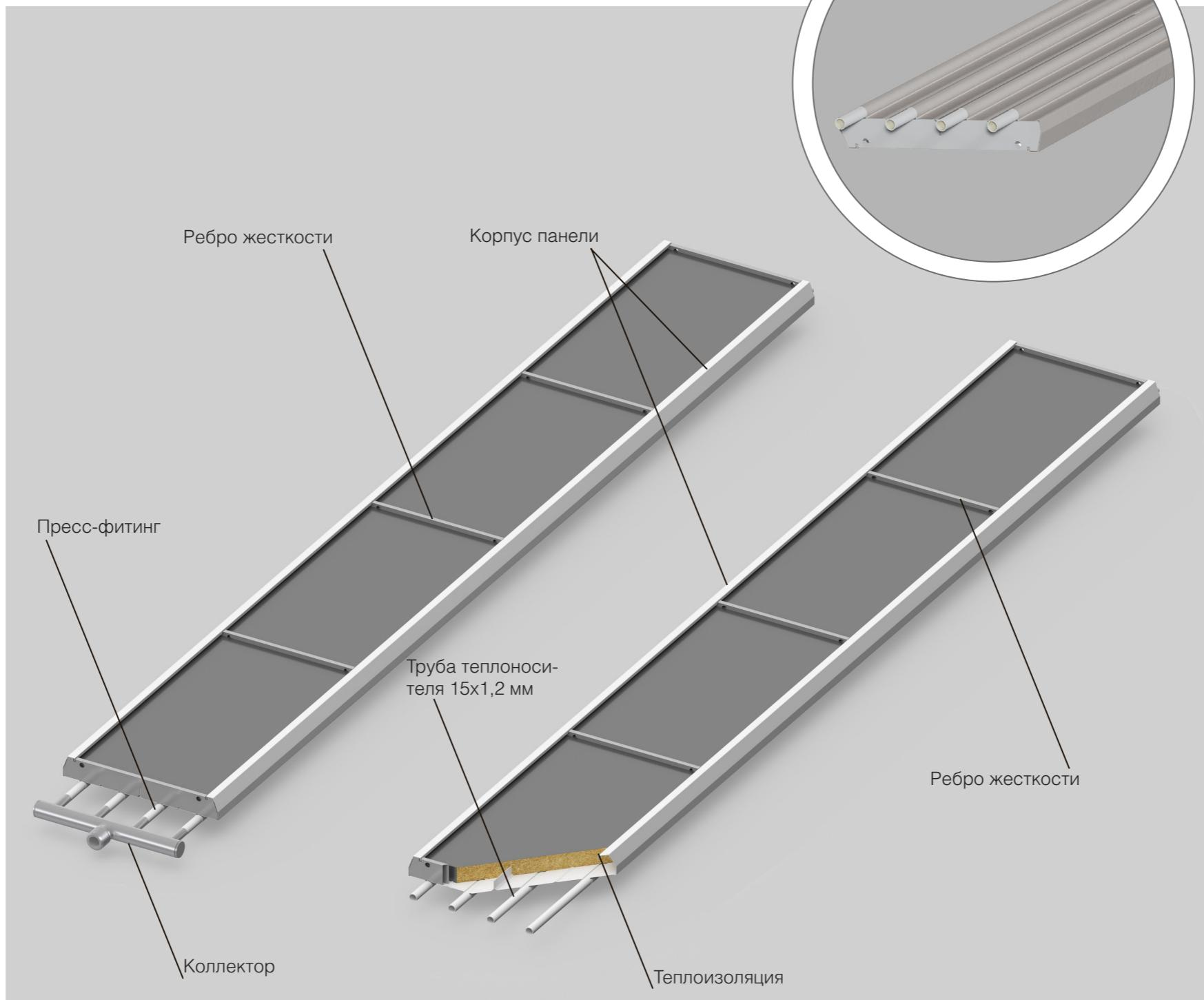
теплопередачи и более надежную фиксацию трубы теплоносителя в корпусе панели. Таким образом, по сравнению с аналогами панели Экотерм Про обладают повышенной мощностью, которая не изменяется в течение всего срока эксплуатации.
