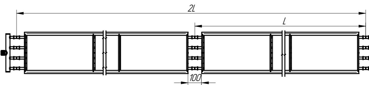
Последовательно панели могут быть соединены в конструкцию практически любой требуемой длины. При последовательном соединении стальные трубы водяного контура соединяются с помощью прессфитингов, поставляемых в качестве дополнительного оборудования, обговариваемого при размещении заказа.
